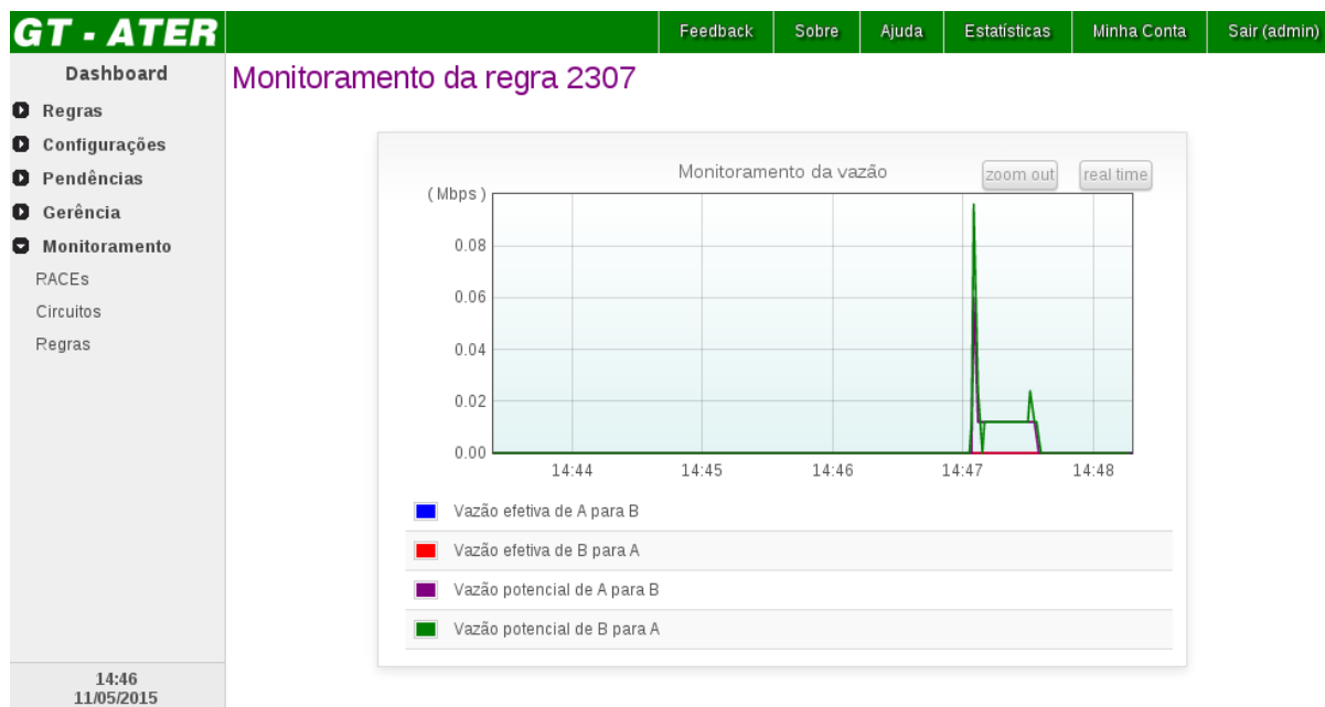
Imagem 2: Gráfico de monitoramento da vazão dos dados que estão trafegando durante a execução do MTR pela rede IPÊ.
